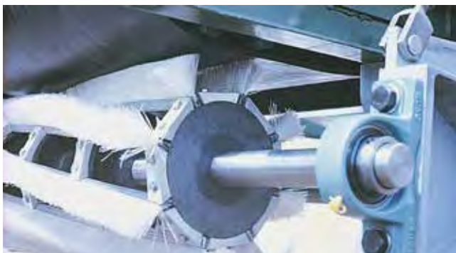
La foto indica la giusta flessione dei filamenti e la corretta pressione tra spazzola e nastro. / The picture shows the recommended bending stress of the filaments and the correct pressure between the brush and the belt.
