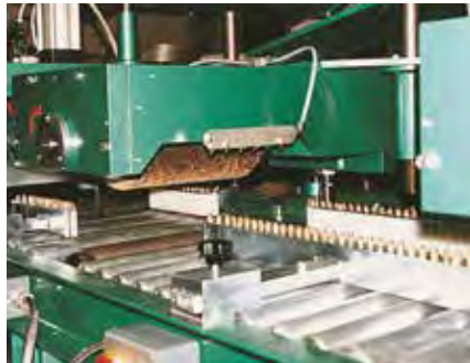
Raspatura del prestampato / Precured tread buffing
