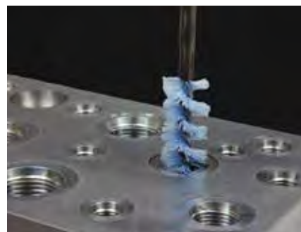
Scovolo ceramico per sbavare fori / Ceramic twisted in brush for holes deburring
