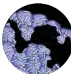
Frattura abrasivo ceramico speciale / Special ceramic filament fracture
