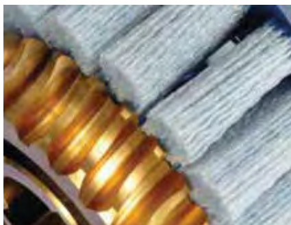
Rifinire ingranaggi in leghe leggere / Light alloys finishing
