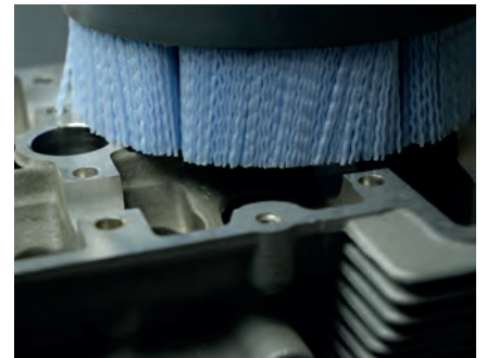
Spazzola a disco su mandrino porta fresa per centri di lavoro automatici / Disc brush with shell-mill holder for CNC and robotic cells
