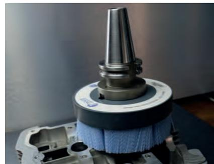
Spazzola a disco su mandrino porta fresa per centri di lavoro automatici / *Disc brush with shell-mill holder for CNC and robotic cells*
