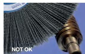
**Regolare il consumo del filamento / Filament wear compensation**
