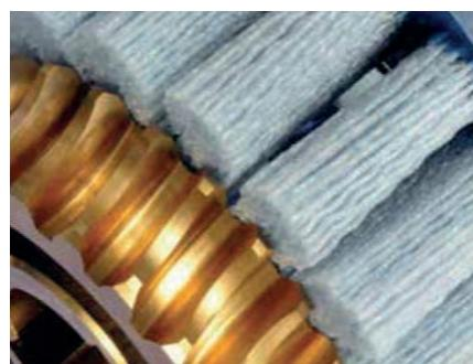
Finition des engrenages en alliage léger / *Light alloys finishing*
