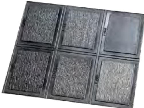
La texture ottenuta alla fine del processo di raspatura è importantissima per l'aderenza del nuovo battistrada che andrà applicato. Varia in base al tipo di ruota trattata e viene verificata con tabelle di controllo RMA (vettura privata → RMA 1-2, macchina movimento terra → RMA 2-3-4).
