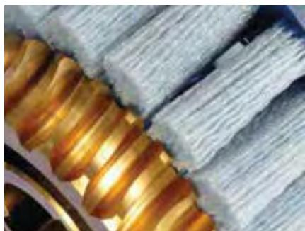
Rifinire ingranaggi in leghe leggere / Light alloys finishing
