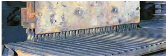
Il sistema a spazzola rotante esegue la pulizia del carosello tramite una spazzola a settori elicoidali montata trasversalmente e operante a carosello in movimento.
