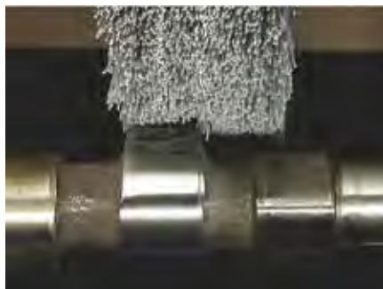
Rifinire albero a camme in acciaio / Steel camshaft finishing
