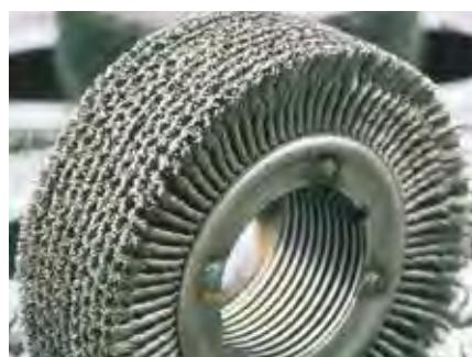
Spazzola a rullo per l'industria del Pipeline / Roller brush for the Pipeline industry
