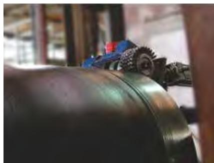
Spazzola a mazzetti ritorti che lavora su una testata di tubo / Twisted knot brush processing a tube end
