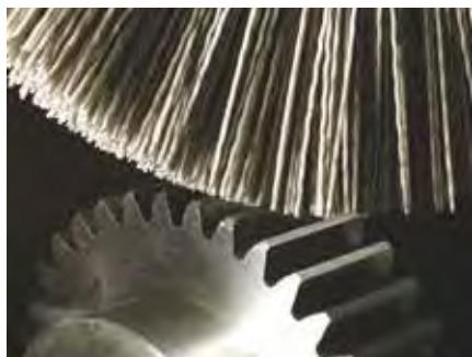
Spazzola in Carburo di Silicio per sbavare ruote dentate / Silicon carbide brush for gear splines deburring
