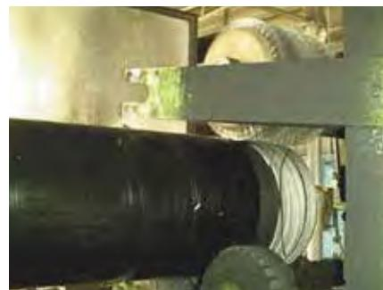
Testa di tubo spazzolata in una stazione di linea automatica / Pipe head inside a cutback automatic station
