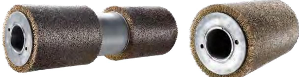
Per ottenere una perfetta aderenza alla carcassa della nuova fascia di battistrada è fondamentale irruvidire la parte interna del prestampato. L'operazione viene svolta con spazzole cilindriche ad altissima densità di filamento in Liz, montate su macchine spazzolatrici. Viene scelta una configurazione di fili diversa a seconda della percentuale di gomma presente nella nuova fascia; per spazzolature più marcate si usano monofili in acciaio ottonato.
