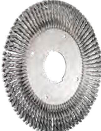
L'asportazione del rivestimento in polietilene (PE), polipropilene (PP) e resine epossidiche dalla testata di tubi è un'operazione critica ed una spazzola performante incide fortemente sulla produttività e sulla qualità dell'output. Per questa applicazione vengono utilizzate spazzole circolari a mazzetti ritorti in acciaio temprato di qualità superiore composte da più anelli forniti sia singolarmente sia già assemblati (ANU).
