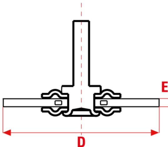
Spazzole circolari con gambo 6x21mm – 1/4"x7/8" in filo d'acciaio ottonato e inox ondulato.
