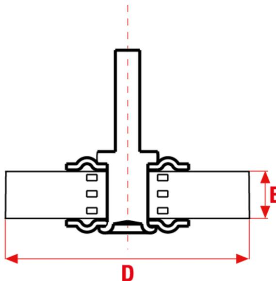
Spazzole circolari con gambo, in acciaio ondulato ad alta resistenza e ad altissima densità di filo. Assicurano lunga durata e grande resa nelle varie lavorazioni industriali. Adatte anche al montaggio su macchinari fissi e centri di lavoro. Le GG sono ingegnerizzate per lavori gravosi e con maggiori velocità di rotazione. Ciò permette di ottenere il risultato desiderato in minor tempo e maggior aggressività. Montabili anche su utensili ad aria.
