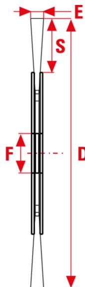
Spazzole circolari in filo ondulato adatte a lavori di “taglio” su superfici irregolari, con spigoli, profili e fessure. In acciaio ondulato ad altissima resistenza, queste spazzole sono compatte, aggressive e sicure. La serie 3000 è adatta per mini smerigliatrice.
