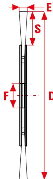
Spazzole circolari in filo ondulato adatte a lavori di taglio su superfici irregolari, con spigoli, profili e fessure. In acciaio ondulato ad altissima resistenza, queste spazzole sono compatte, aggressive e sicure.
