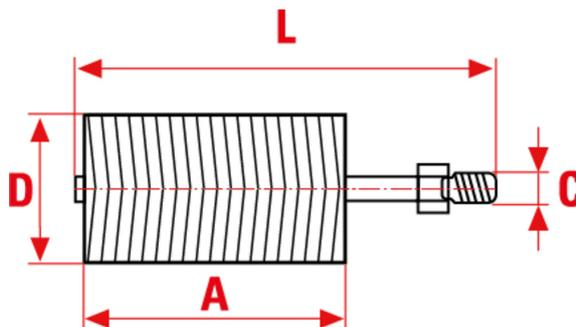
Scovoli in acciaio e acciaio inox per lavori di precisione. Possono essere utilizzati sia manualmente sia con utensile elettrico sia con macchine CNC. Su richiesta, sono disponibili attacchi filettati differenti.
