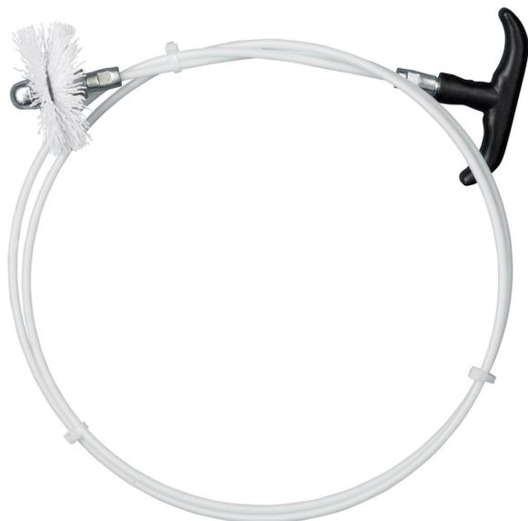
Kit costituito da un'asta in vetroresina estremamente resistente e flessibile, una maniglia in plastica che ne facilita l'utilizzo, 1 o 2 anelli di nylon di prima qualità ed una chiusura con dado M12 (KIT Light) o con sfera nera M12 che guida lo scovolo anche nelle curve di 90°!
