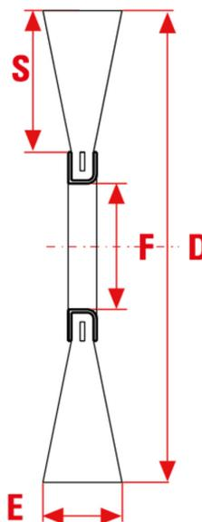
Le circolari copper center CCW hanno profilo sottile, alta densità di filamento e perfetta simmetria costruttiva in modo tale da permettere montaggio singolo o a pacchetto, su gambo o mandrino per centro di lavoro a controllo numerico.
