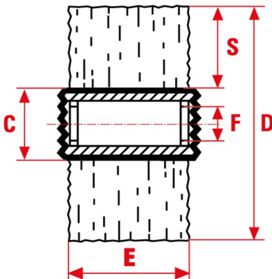
Spazzole cilindriche punzonate modulari di lunghezza standard 100 mm e passo 15mm, dentate ai lati per formare rulli di qualsiasi lunghezza. Gli RMD sono autotrainanti grazie ai collarini TD dotati di 3 grani ciascuno e posti all'estremità del rullo.
