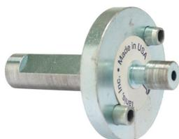
Alberi adattatori per spazzole a disco e mini disco con perni di centraggio e trascinamento, gambo di diametro 12mm (ref 0587) o 19mm (altre ref) con foro passante per il fluido lubro-refrigerante.
