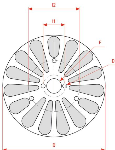
Alberi adattatori per spazzole a disco e mini disco con perni di centraggio e trascinamento, gambo di diametro 12mm (ref 0587) o 19mm (altre ref) con foro passante per il fluido lubro-refrigerante.
